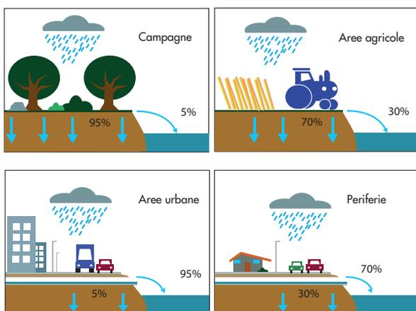
**Fig. 1** - Ciclo delle acque: zone naturali e impermeabilizzate
